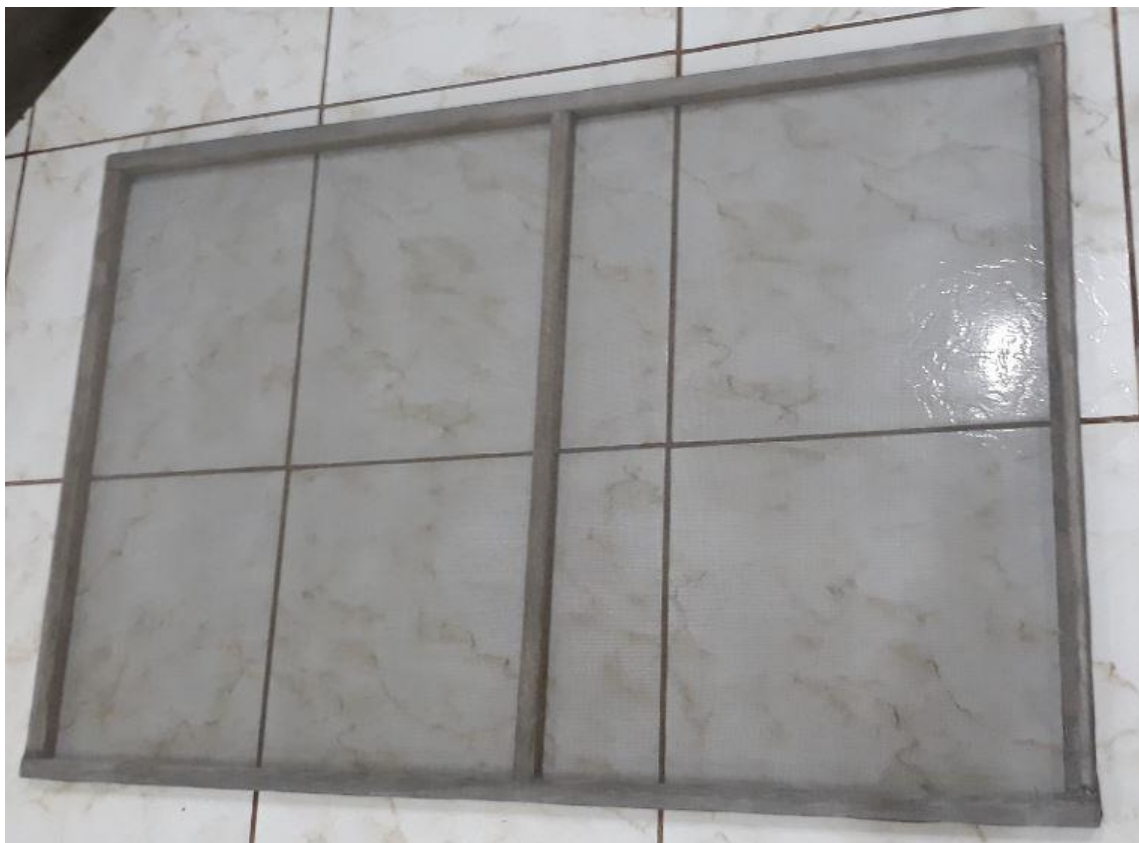
Figura 1 – Tela para janela confeccionada em madeira
