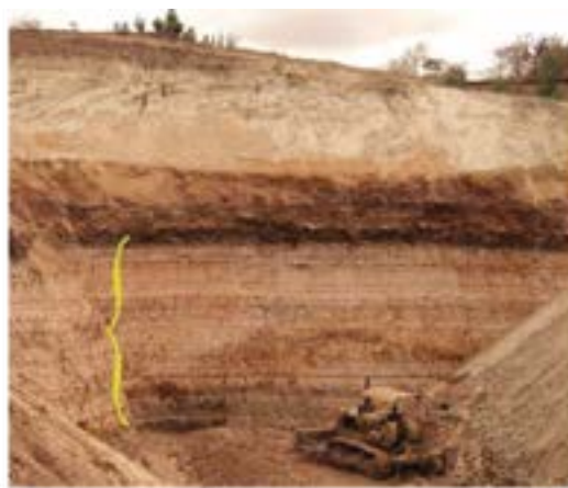
FIGURA 5: VISTA DOS NÍVEIS DE BENTONITA NA MINA JUÁ II, BOA VISTA -PB. FONTE: (PANIZ, 2015)
