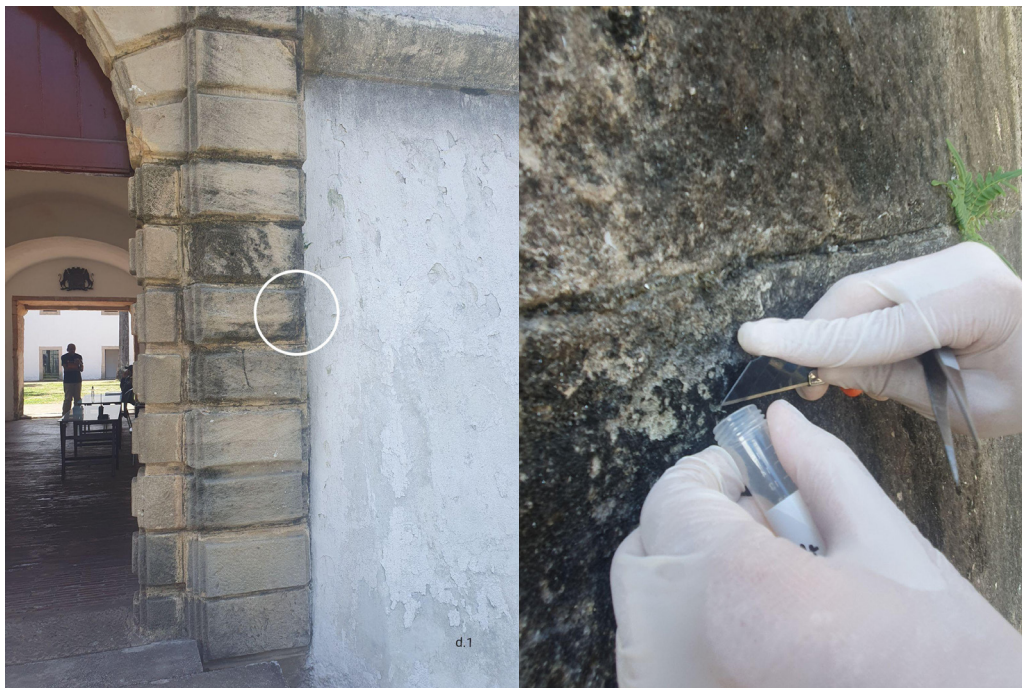
FIGURAS 11 E 12. INDICAÇÃO DO LOCAL EXATO DE RETIRADA DAS AMOSTRAS E.1 E D.1, RESPECTIVAMENTE.
