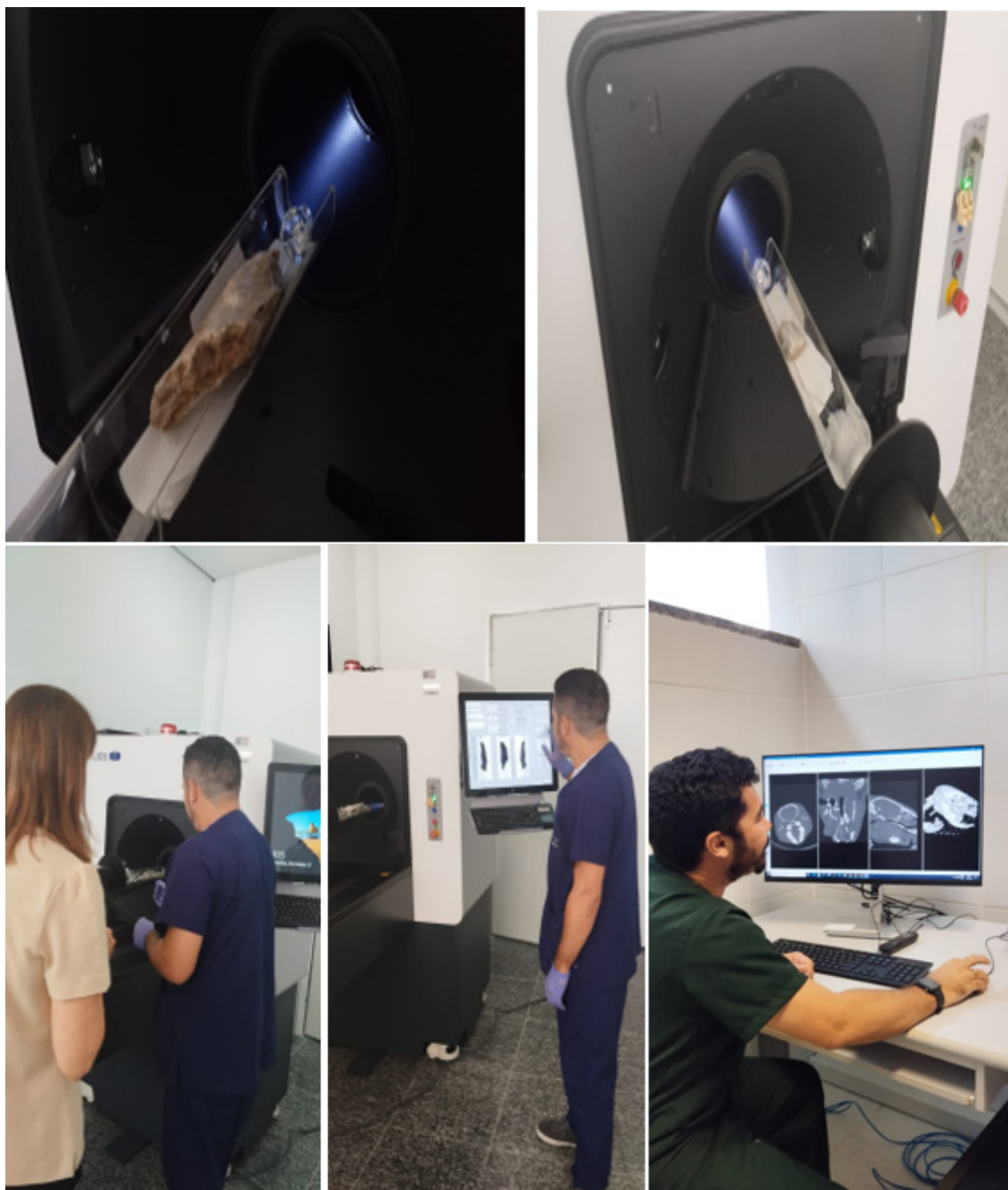
FIGURA 08: VISTA DE DIFERENTES MOMENTOS DURANTE UTILIZAÇÃO DE MICROTOMOGRAFIA COMPUTADORIZADA PARA ANÁLISE DE AMOSTRAS PALEONTOLÓGICAS E DE RATOS (PESQUISA CLÍNICA).
