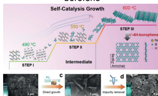
Fig. 2 Processo de hidrogenação do borofeno
