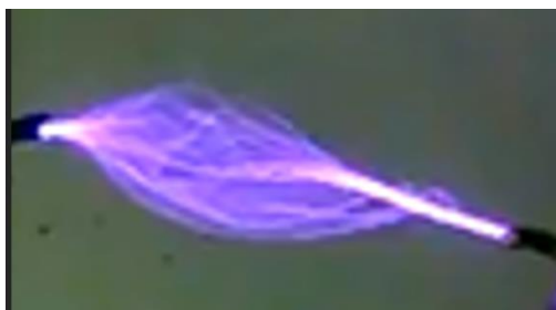
Figura 1- B: Arco elétrico de aproximadamente 7mm (Fonte: Autores).
